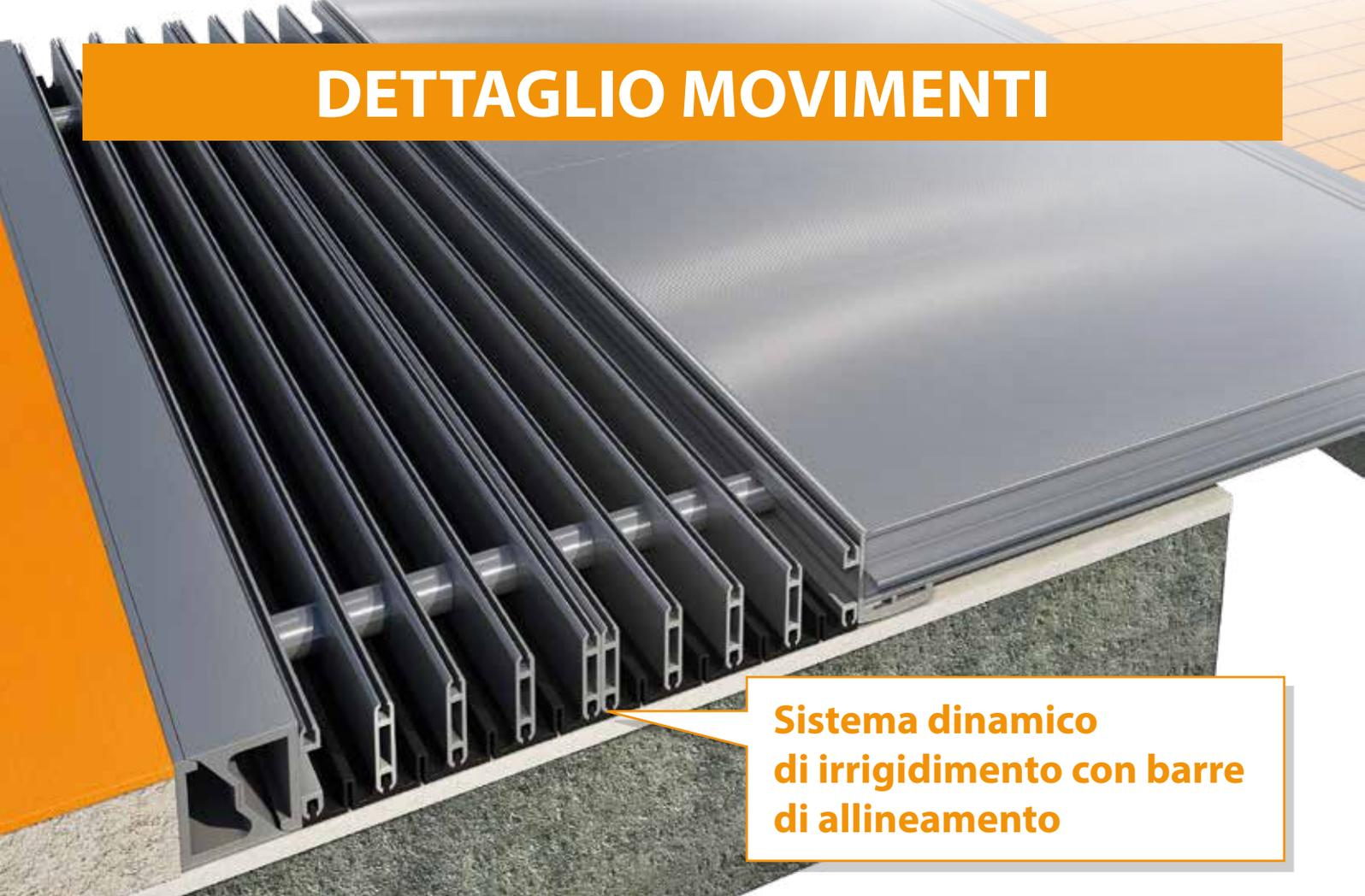
**Sistema dinamico di irrigidimento con barre di allineamento**
